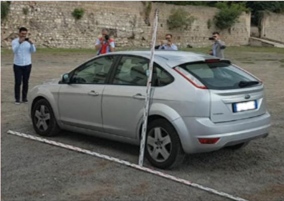
La fotogrammetria digitale automatica consiste nell'elaborazione del modello tridimensionale partendo da immagini bidimensionali. In parole povere, da alcune foto di un oggetto si può ottenere un modello tridimensionale con contenuto fotorealistico.
